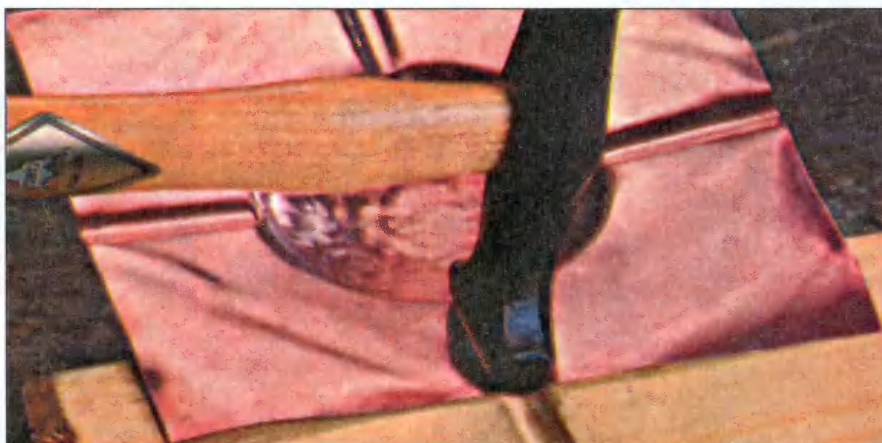
Фото 7. Желобки для сигарет можно сделать с помощью самодельной формы из древесины сосны. Соответствующие пазы в форме выбирают круглым напильником, так называемым "крысиным хвостом". Выколотку по форме производят фигурным молотком.
