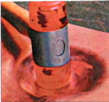
Фото 4. Для придания заготовке грубой формы достаточно пластикового молотка, в том числе и при обработке меди толщиной 2 мм.
