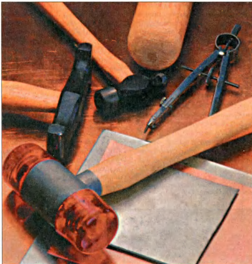
Фото 1. Для чеканки металла требуется следующий набор инструментов: циркуль, разгонный молоток, фигурный молоток и молоток из пластмассы. Монтажный брусок и подложки вы можете сделать сами.
