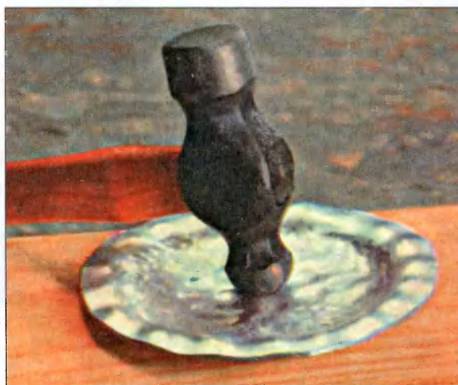
Фото 9. Хорошо поддается обработке и мягкий листовой алюминий. Сначала разгонным молотком делают углубление, а затем фигурным молотком закругляют края.
