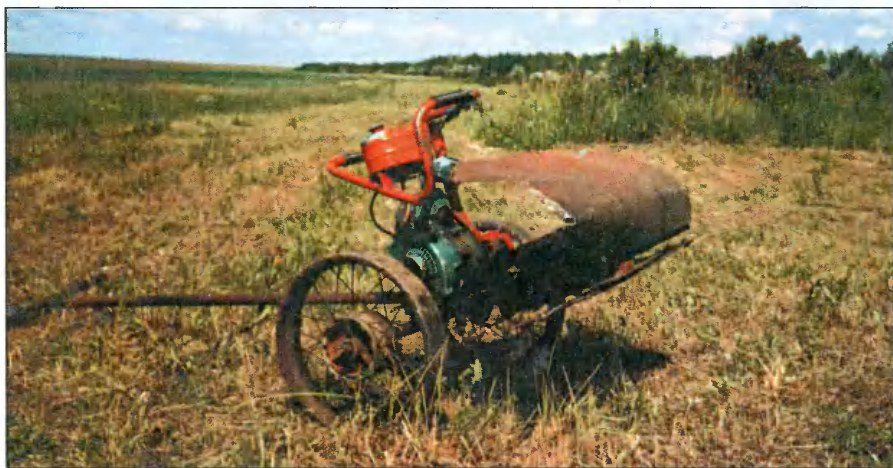
Альхамов Рафик Гайсеевич из Башкортостана (пос.Целинный), 1948 г. рождения. Собрал минимотокосилку с двигателем от бензопилы «Дружба».
